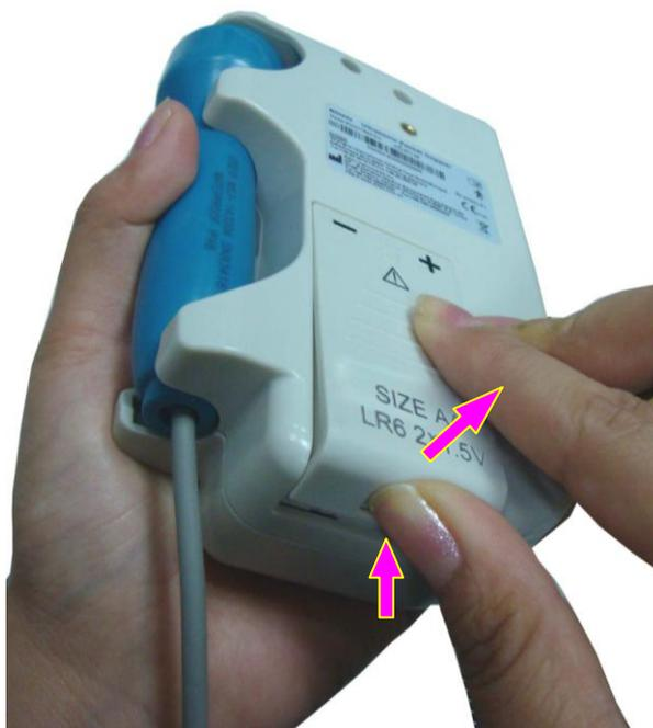
Figure 3-1 Ouverture du compartiment de la batterie
