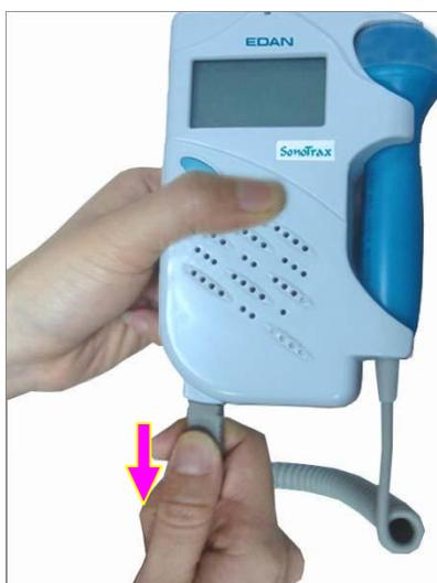
Figure 3-6 Débranchement de la sonde
