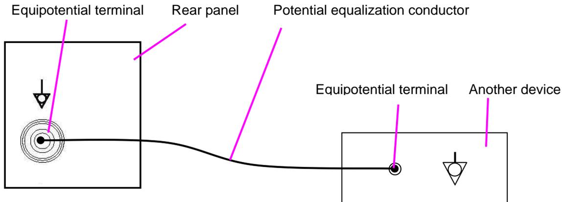
Figure 4-8 Equipotential Bonding
